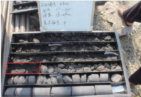
(b) 新滑坡滑带角砾土滑带特征
