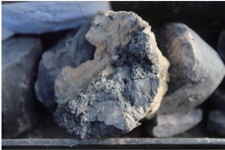
(a) 老滑坡滑带泥化夹层滑带特征
