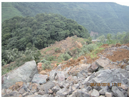
图4 滑坡前部反向堆积
