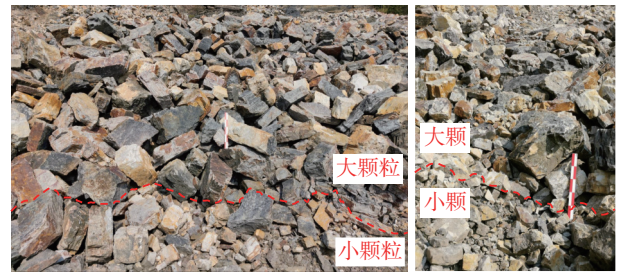
图8 堆积体内存在的反序现象
