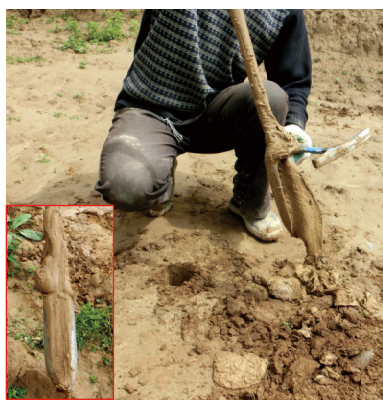
图 13 饱和滑体振动液化现象
