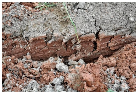
图 14 主沟道中的饱和滑带与液化现象
