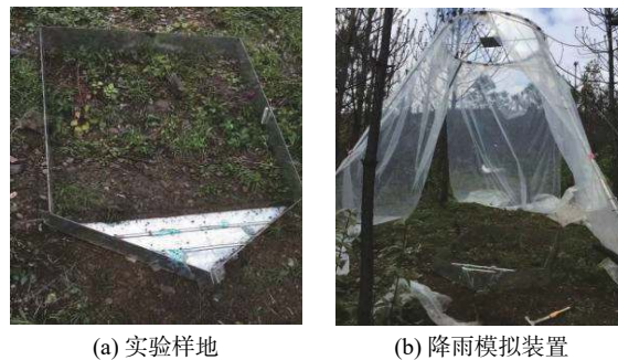
图 8 基于火烧迹地侵蚀的降雨模拟试验
